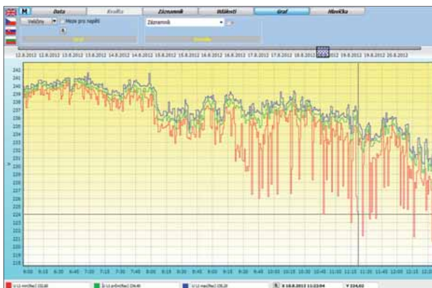
Obr. 5. Detail průběhu průměrného a 200ms maximálního i minimálního napětí fáze L1
