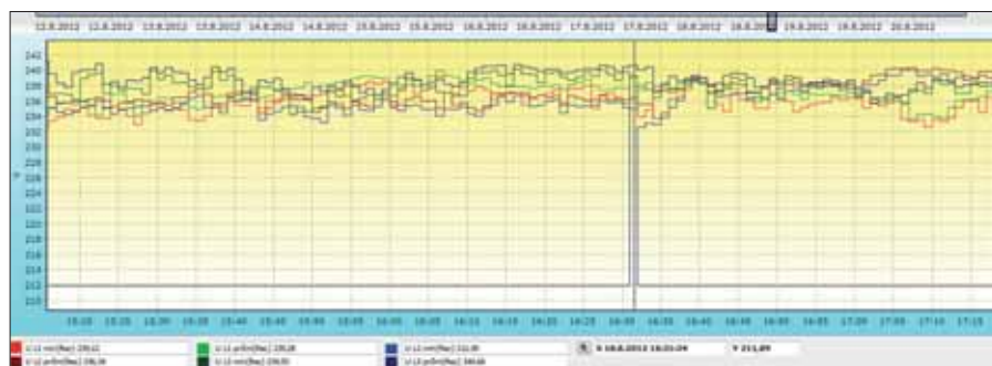
Obr. 10. Průběhy průměrných a minimálních fázových napětí při zkratu
