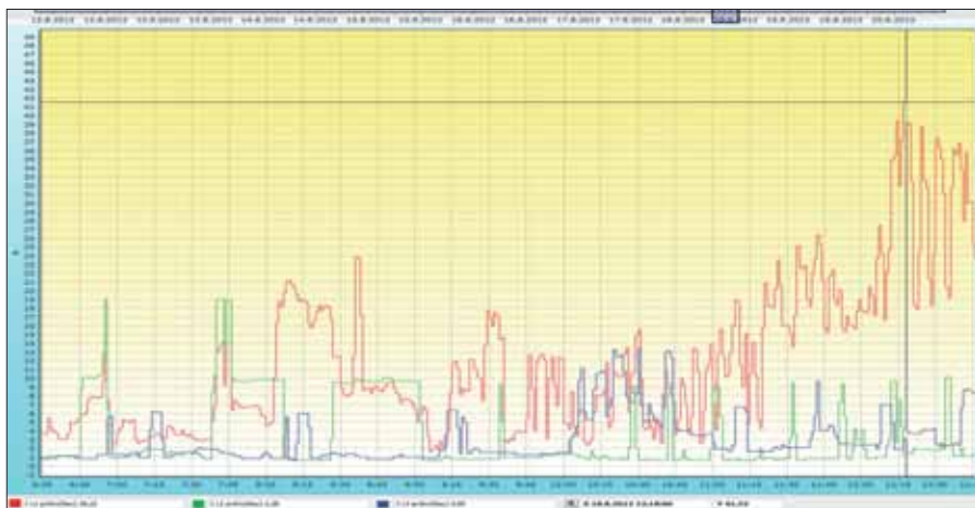
Obr. 7. Fázové proudy vývodu nn v místě měření
